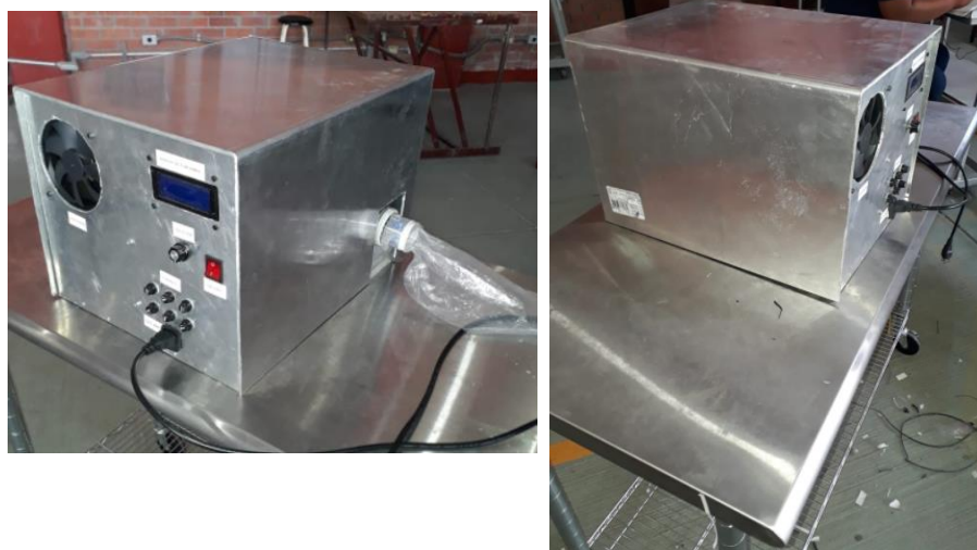
Ilustración 78 Prototipo para Automatizar un Respirador Manual
